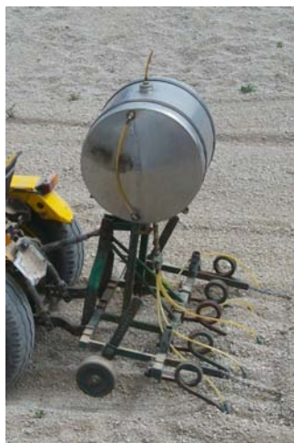
Foto 2 y 3: Inyección de la aplicación del metam sodio.
