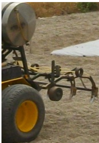
Foto 2 y 3: Inyección de la aplicación del metam sodio.
